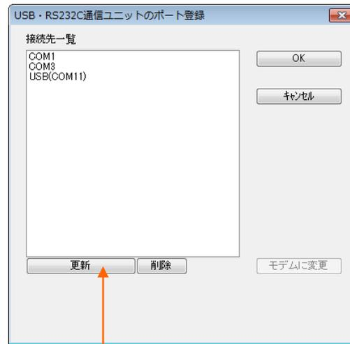
USB 通信ユニットは PC が認識している COM ポートが対象となるため、更新ボタンで接続可能な通信ユニットの一覧を再取得します。
